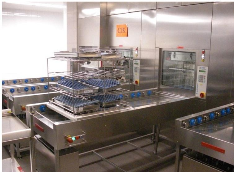
2 Containerwaschanlagen: speziell für die Reinigung von Containern
